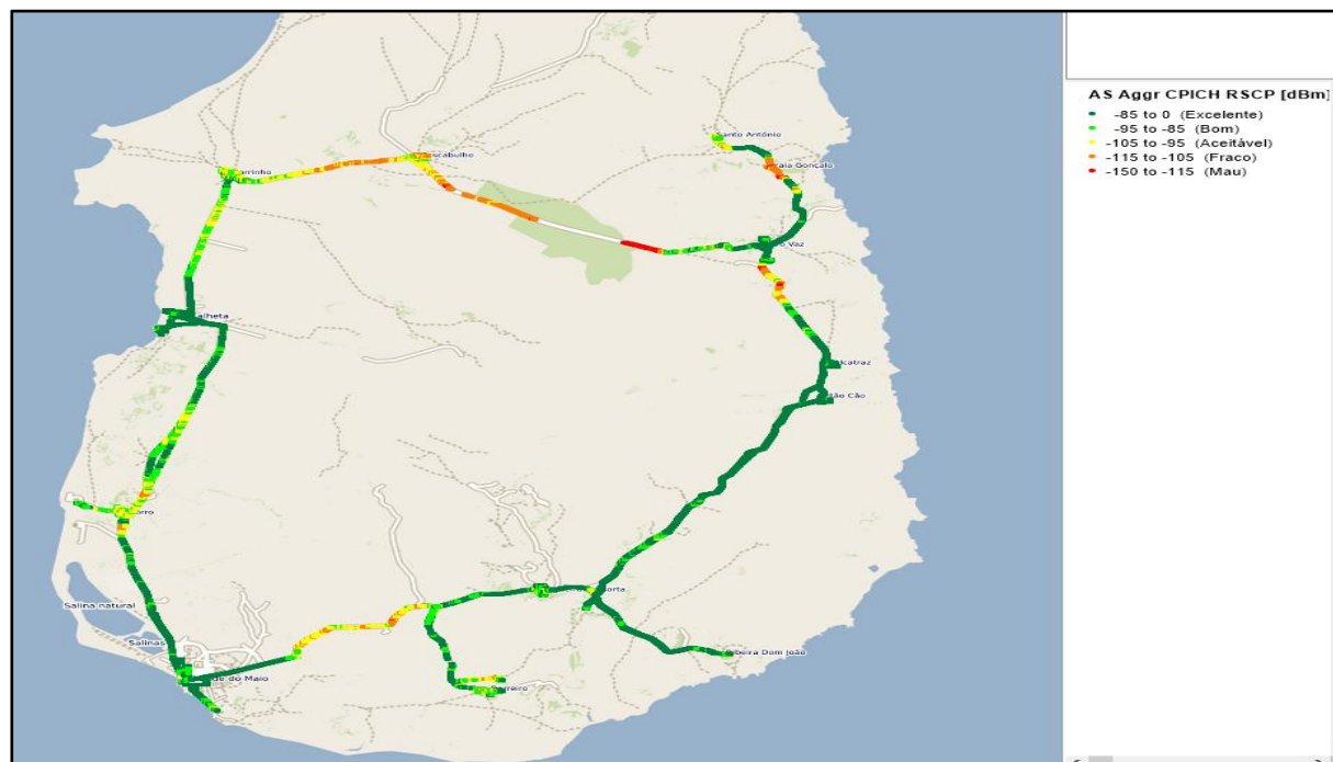
Figura 23- Cobertura rede móvel da CVMóvel nas localidades– UMTS
